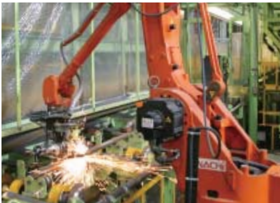
優れた表面品質を確保する一方、作業環境も改善する世界初の自動きず取りロボット
